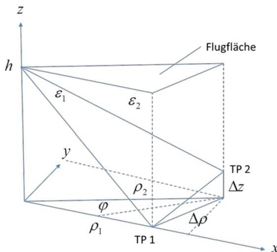
Abbildung 1. Schematische Anordnung zur Peilung zweier topographischer Punkte von einer Flugfläche aus
