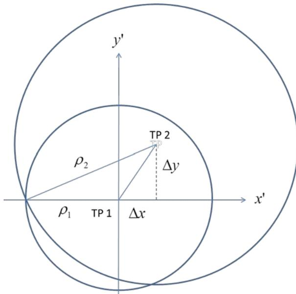
Abbildung 2. Positionsbestimmung mittels Schnittpunkten zweier Kreise
